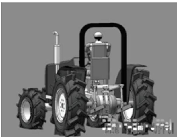
Figura 1: Estrutura de proteção contra o capotamento do tipo arco simples.
